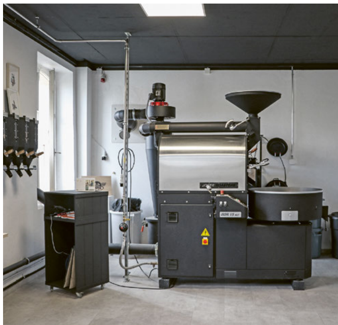
Le gaz est un agent énergétique utile dans les procédés de fabrication. Un fournisseur de café torréfié, établi sur le réseau de Cosvegaz SA, utilise un torréfacteur alimenté en gaz pour sa production.
